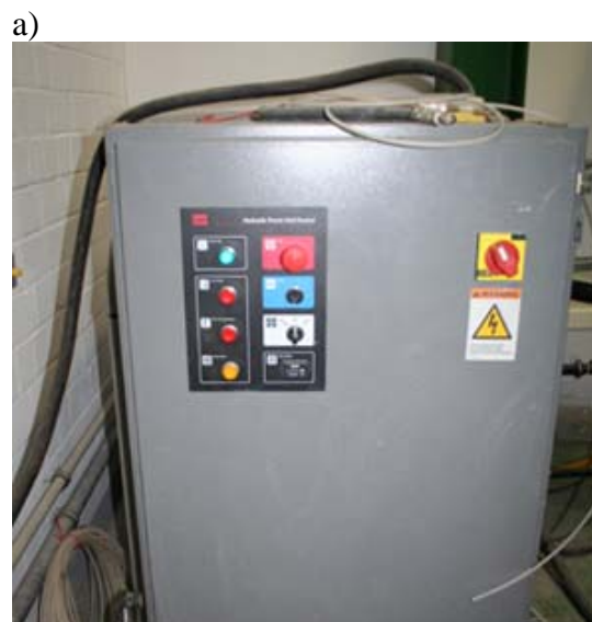
Bild G.1: a) Hydraulikaggregat, b) Servoregler
