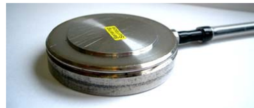
Bild G.3: Skizze und Ansicht der Erddrucksensoren, aus Witzel (2004)
