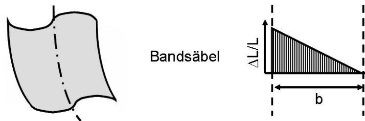
Bild 2-7: Planheitsdefekt „Bandsäbel“ und Längenverteilung \Delta L/L , vgl. [Neus86]
