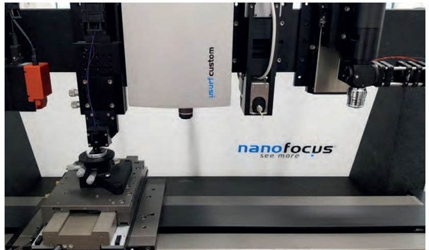
Abb. 1: Multisensor-Messsystem des Fachgebiets Messtechnik mit (von links nach rechts): Rasterkraftmikroskop (Nanite AFM), interferometrischem Punktsensor (Eigenbau), konfokalem Mikroskop (Nanofocus µsurf 100x), taktilem Tastschnittgerät (Mahr GD26), kamerabasiertem Mirau-Interferometer (Eigenbau) und luftgelagertem Messtisch.
