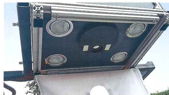
Rund um die Kamera sind vier Halogen-Lampen angeordnet, die den Boden beleuchten. Fotos: Gödeke, Höing
