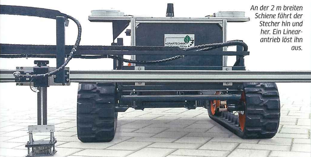
Der Stecher besteht aus einer Nagelplatte und einem Abstreifer in Form einer Lochplatte.
