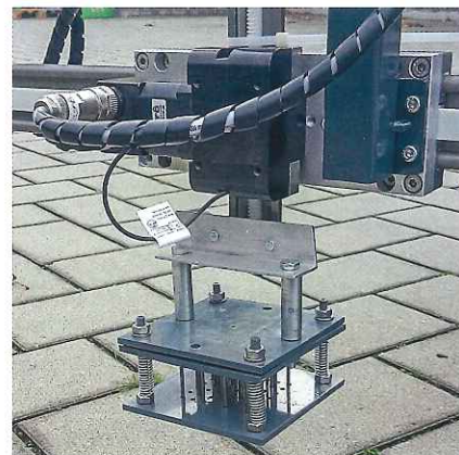
Der Stecher besteht aus einer Nagelplatte und einem Abstreifer in Form einer Lochplatte.
