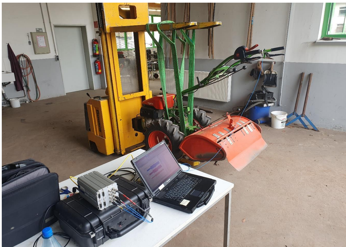
Bild 3: Vorversuch: Schallmessungen zur Bestimmung der Vibrationen am Lenker eines Verbrenners Quelle: Christoph Besse
