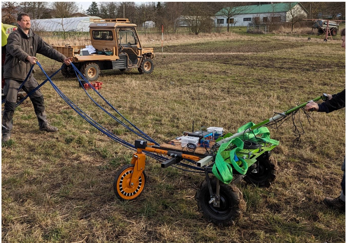
Bild 1: Elektrisch angetriebene Hacke mit Messtechnik zur Bestimmung der Maximalleistung Quelle: Carsten Bruckhaus
