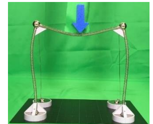
Abb. 2: Verformung an Rahmen durch vertikale Einzellast im Greenscreen
