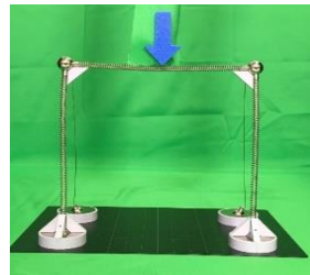
Abb. 2: Verformung an Rahmen durch vertikale Einzellast im Greenscreen
