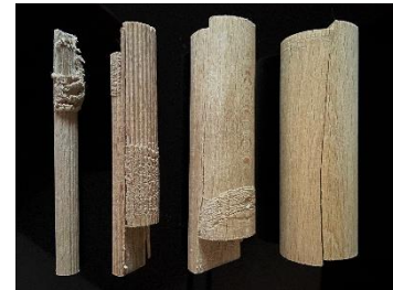
Abb. 3: Schubversagen an Dübeln
