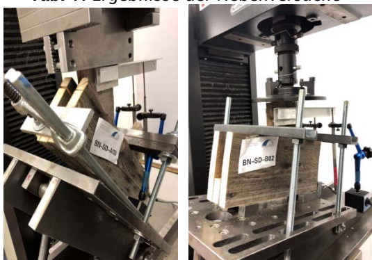
Abb. 2: Versuchsaufbau der Zug- und Druck-Scherversuche
