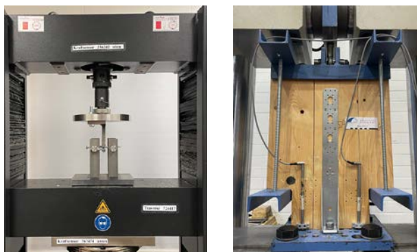
Abb. 1: Aufbau Biege- und Zugankerversuch
