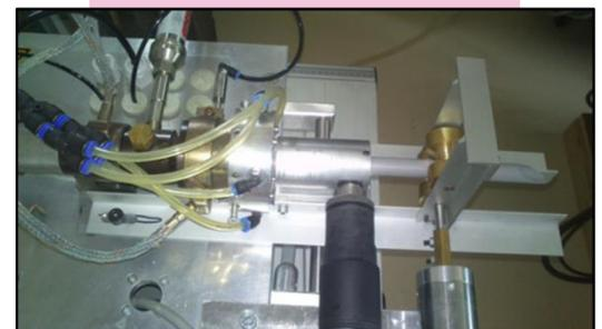
Extrusion mit Vakuumabziehvorrichtung von gefülltem PP
