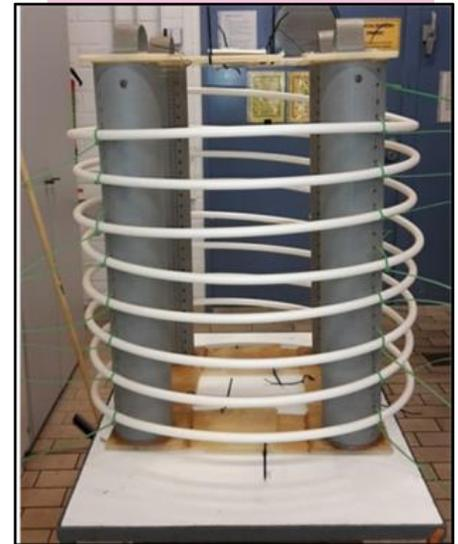
Wärmeübertragerwendeln aus PP, gefüllt mit Bornitrid, auf Halterung
