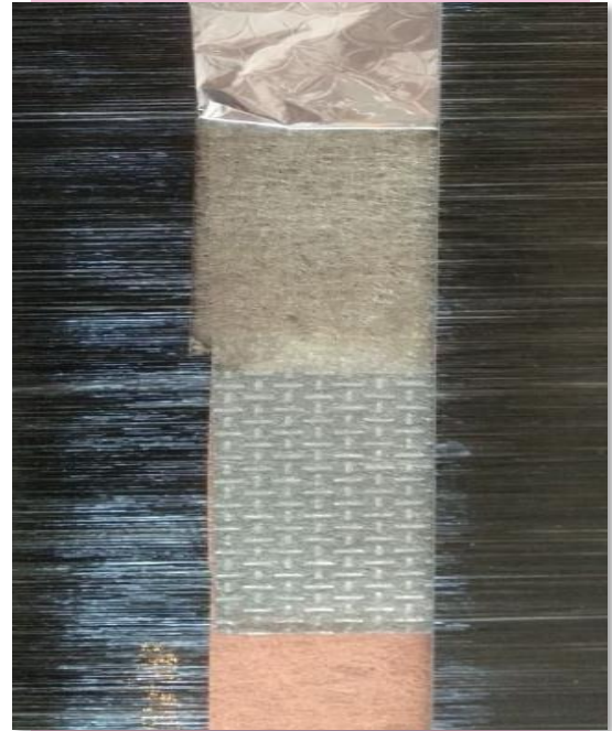
Abb. 1 Schematische Drapierung vier unterschiedlicher EMV-Lagen im Verbund
