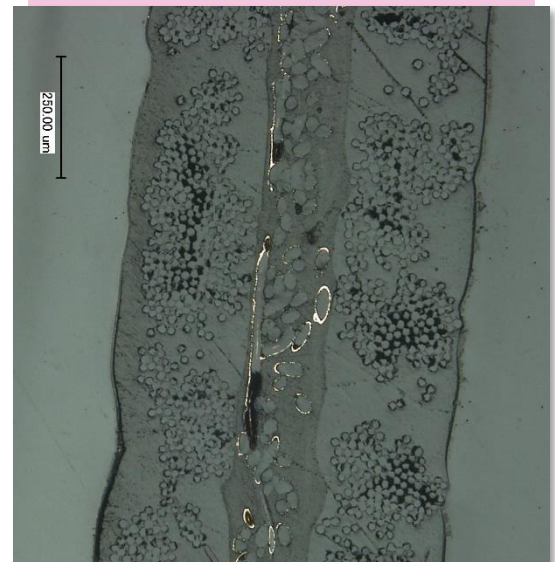
Abb. 2 Mikroskopische Bewertung eines Thermoplast-GF-Verbundes mit integriertem EMV-Schutz
