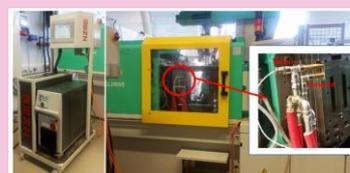
Abbildung 1: Wenz Temperiertechnik zur variothermen Beheizung von Spritzgießwerkzeugen (links), Realisierung an der Arburg SGM im Labor von UNIpace (rechts)
